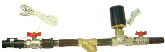
Узел регулирования состоит из клапанов соответствующего расхода и приводов на каждый из клапанов. При установке клапанов рекомендуется в необходимых случаях применять сетчатые фильтры соответствующего диаметра и установить запорную арматуру. При расходах превышающих расход одного клапана возможна параллельная установка клапанов.
